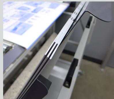
Versetzt sortierte Druckplatten
